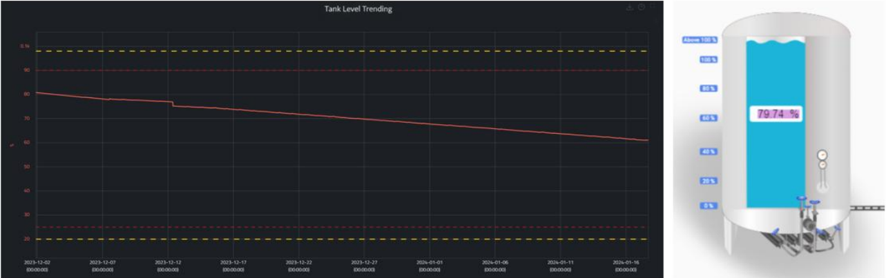
Figura 5: Monitoramento de nível de Tanque (dashboard simples)
